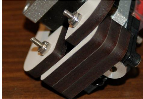
*Fig. 10.2-6: EZStruder installed.*
