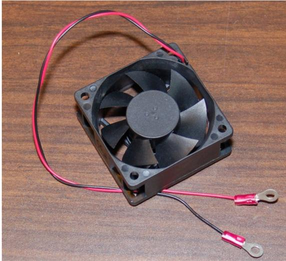
Fig. 3.3-4: Fan crimps.
